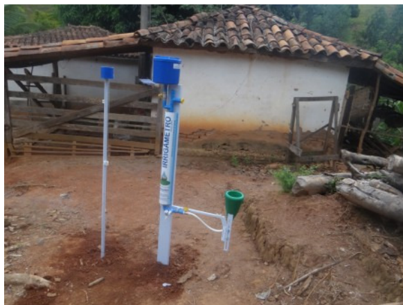
Instalação do Irrigâmetro, na propriedade do produtor Flávio Marçal em Alvarenga - MG
