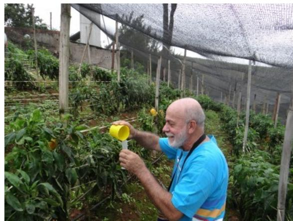
Medição do volume coletado dos emissores do sistema de irrigação na propriedade de Edmilson Nonato Soares.
