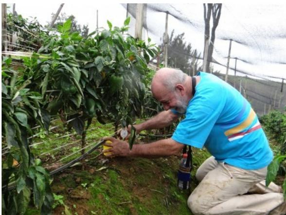
Coleta de água para medição da vazão dos emissores na propriedade de Edmilson Nonato Soares
