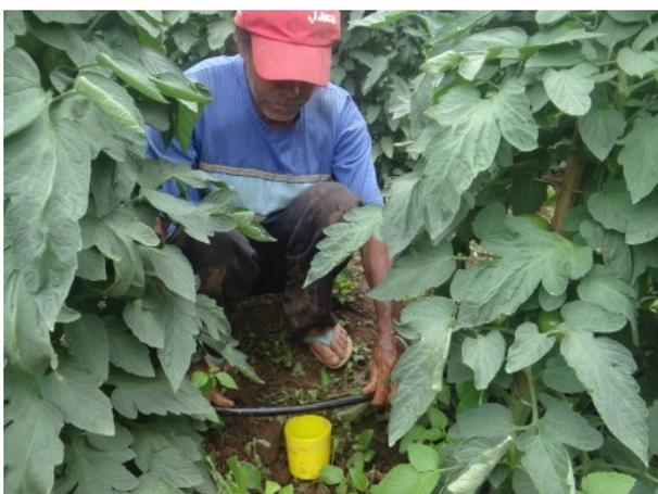
Coleta de água do emissor para caracterização do sistema de irrigação por gotejamento em tomate, na propriedade de Geraci Odorico Dias
