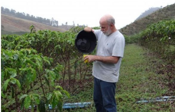
Medição do volume de água coletado do emissor para caracterização do sistema de irrigação por gotejamento em café, na propriedade de Edilson Brandt
