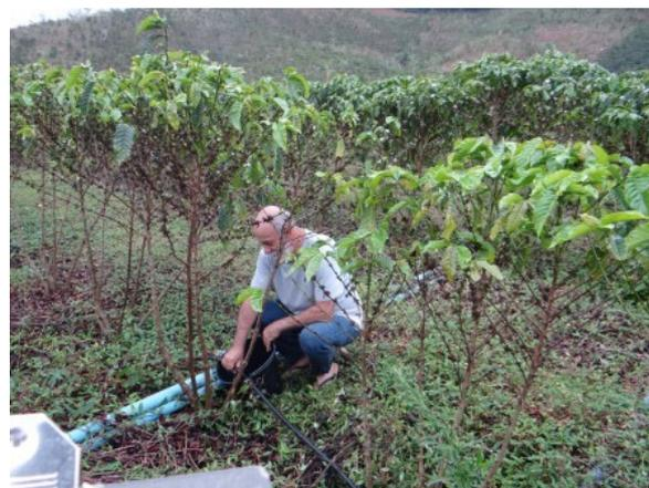
Coleta de água do emissor para caracterização do sistema de irrigação por gotejamento em café, na propriedade de Edilson Brandt
