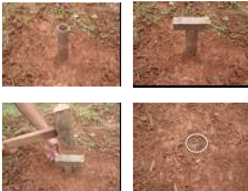
Figura 9. Sequência de cravação do tubo de PVC, com sua borda ficando rente à superfície do solo.
