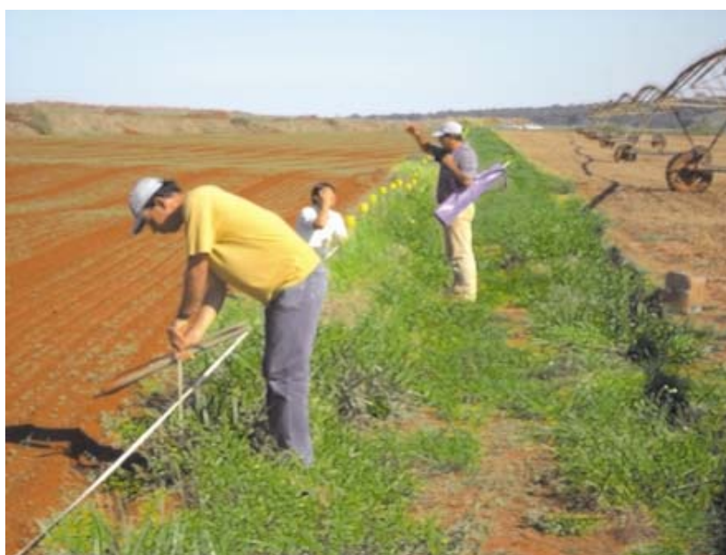
Figura 21. Marcação da posição e colocação dos coletores ao longo de um raio do círculo de molhamento de um pivô central.
