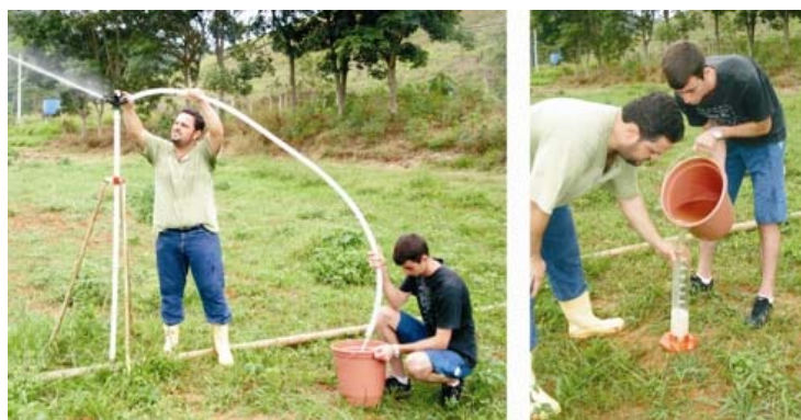
Figura 20. Medição de vazão do aspersor.
