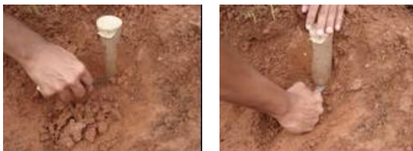
Figura 13. Limpeza do tubo de PVC e corte do solo na sua base, para retirada da amostra.
