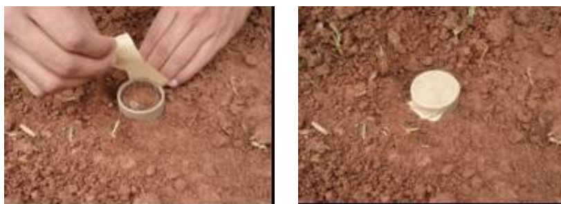
Figura 11. Vedação da borda superior do segmento de tubo de PVC.
