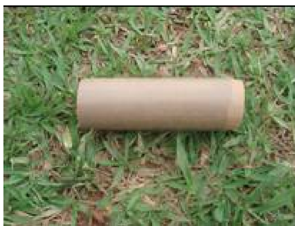
Figura 6. Segmento de tubo de PVC com uma extremidade biselada.
