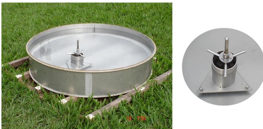
Figura 24. Tanque Classe A com detalhe do micrômetro de gancho.
