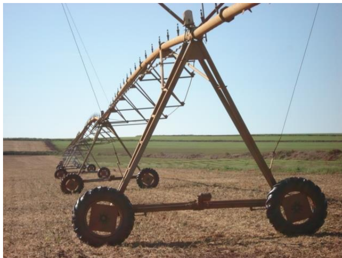
Figura 13. Torre móvel de um pivô central.
