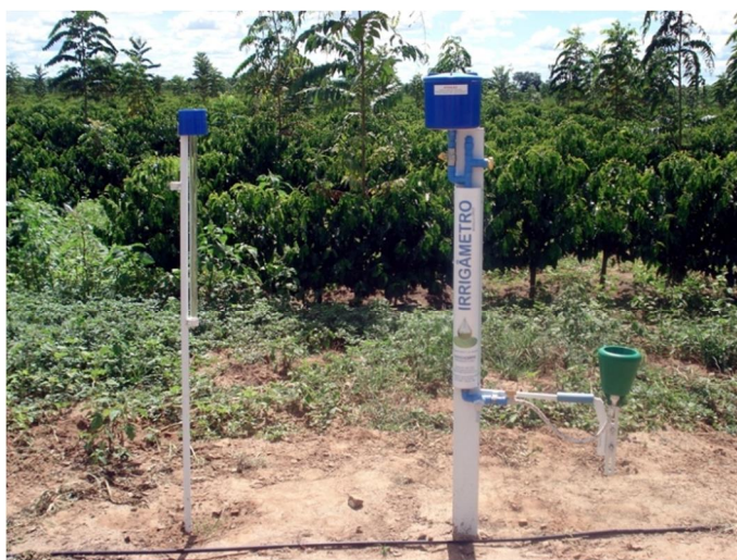
Figura 26. Irrigâmetro usado no manejo da irrigação do cafeeiro.
