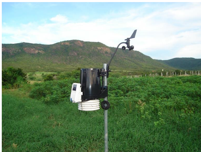
Figura 25. Estação meteorológica automática.
