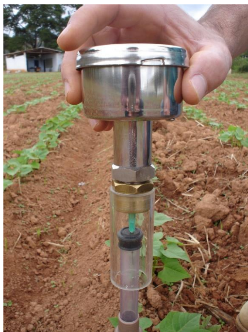
Figura 23. Uso de tensímetro digital e tubo tensiométrico no manejo da irrigação do feijoeiro.
