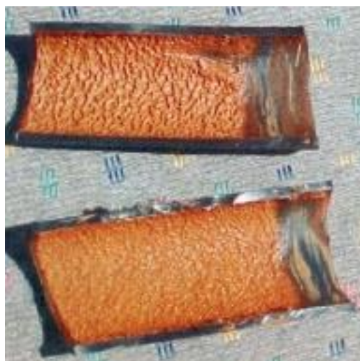
Figura 1. Mucilagem bacteriana formada no interior da tubulação de polietileno.
