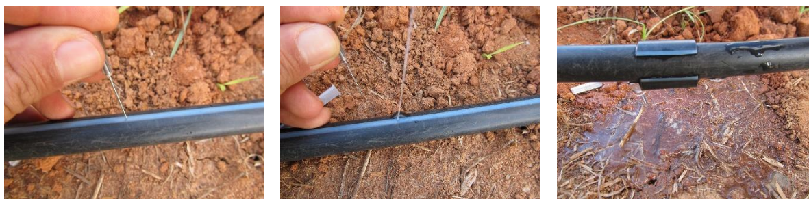
Figura 19. Confeção de sistema alternativo por gotejamento do tipo xiquexique.
