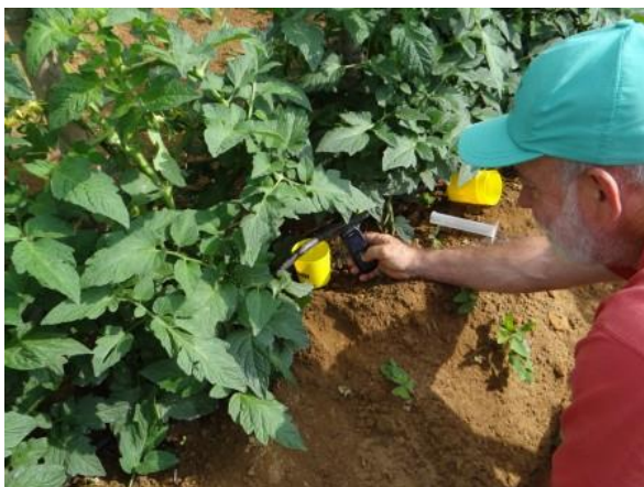
Coleta de água do emissor para caracterização do sistema de irrigação por gotejamento em tomate, na propriedade de Nelson Marques
