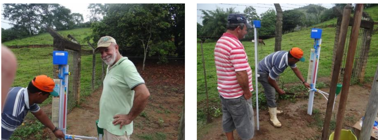
FIGURA 122. Instalação do Irrigâmetro na propriedade e treinamento do produtor José Antônio Rodrigues, do município de Vargem Alegre - MG.
