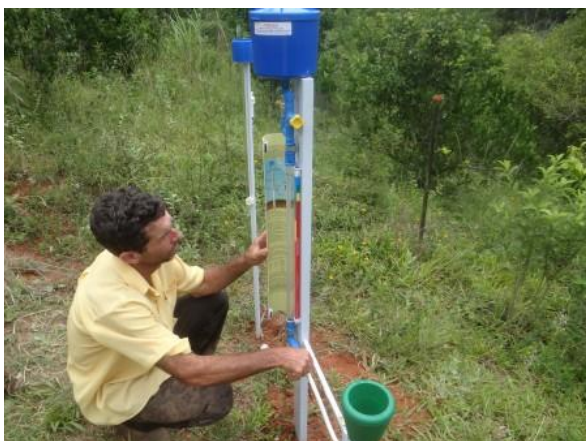
FIGURA 104. Instalação do Irrigâmetro na propriedade e treinamento do produtor Joaquim Carlos Moreira, do município de Inhapim - MG.
