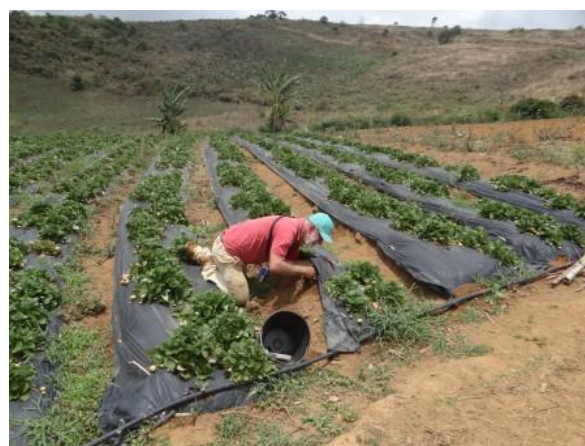
Coleta de água do emissor para caracterização do sistema de irrigação por gotejamento em morango, na propriedade de Miguel José
