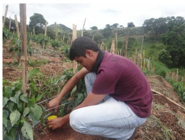
Coleta do volume de água do gotejador para a caracterização hidráulica do sistema de irrigação da na propriedade de Thiago Marçal Gomes Moreira.
