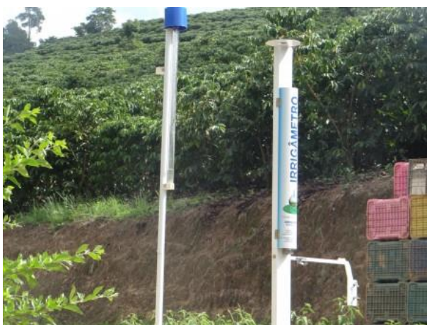
FIGURA 123. Instalação do Irrigômetro na propriedade e treinamento do produtor Alfredo Knaak, do município de Afonso Cláudio - ES.
