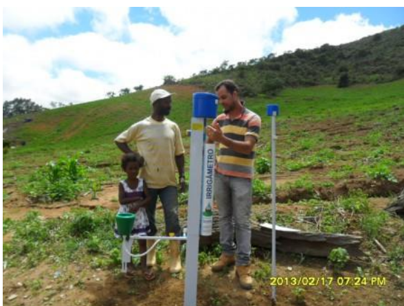
FIGURA 149. Instalação do Irrigâmetro na propriedade e treinamento do produtor Miguel José, do município de Brejetuba - ES.
