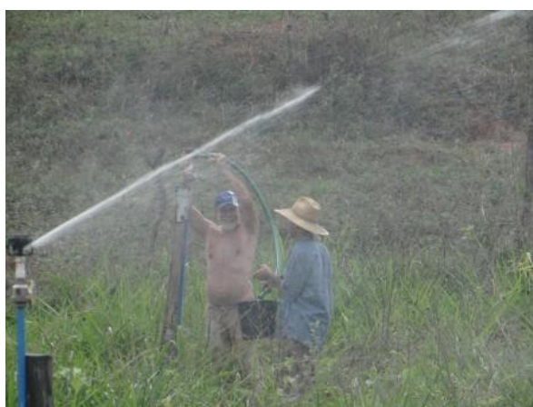
Coleta de água do aspersor para caracterização do sistema de irrigação por aspersão em piquetes, na propriedade de Joaquim Carlos Moreira.
