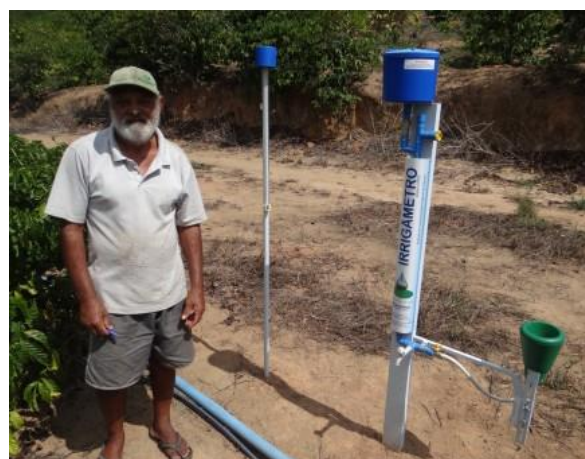
FIGURA 132. Instalação do Irrigâmetro na propriedade e treinamento do produtor Waldemar Alves Pereira, do município de Afonso Cláudio - ES.
