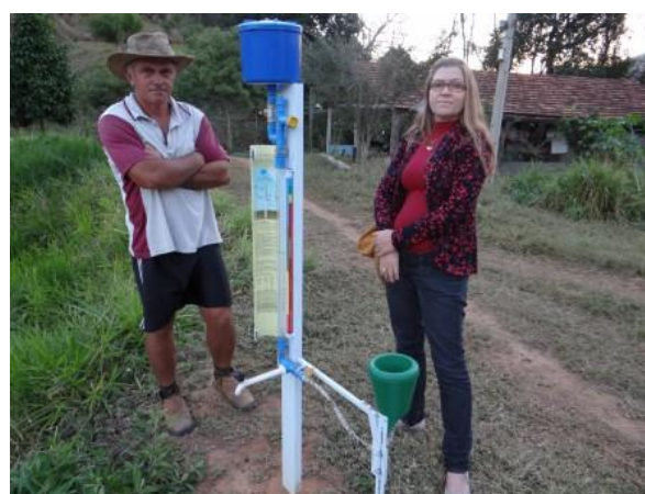
FIGURA 155. Instalação do Irrigâmetro na propriedade e treinamento do produtor Carlos Schultz, do município de Laranja da Terra - ES.
