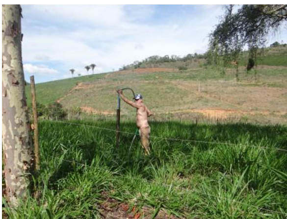
Coleta de água do aspersor para caracterização do sistema de irrigação por aspersão em piquetes, na propriedade de Flávio Dias Fernandes.
