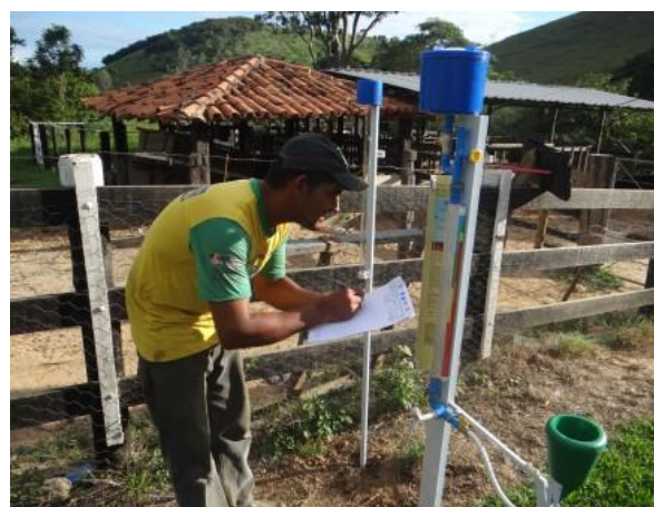
FIGURA 119. Instalação do Irrigâmetro na propriedade e treinamento do produtor José Antônio Rodrigues, do município de Tarumirim - MG.
