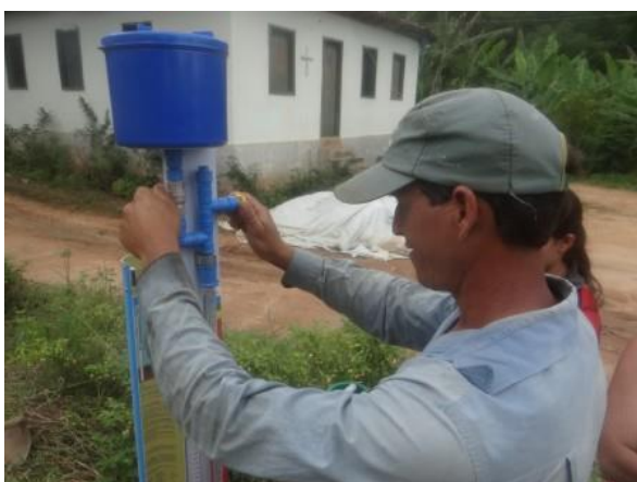
FIGURA 116. Instalação do Irrigâmetro na propriedade e treinamento do produtor Lúcio de Paula Fortunato, do município de Santa Rita de Minas - MG.
