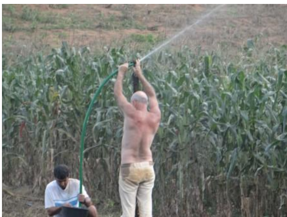
Coleta de água do aspersor para caracterização do sistema de irrigação por aspersão em piquetes, na propriedade de David Augusto Alves
