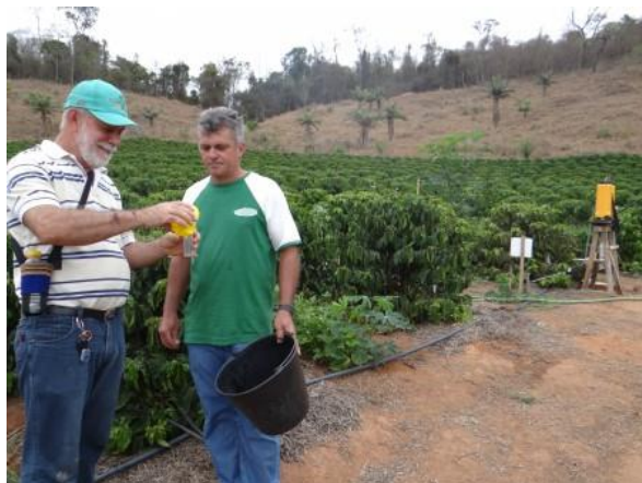
Coleta de água do emissor para caracterização do sistema de irrigação por microaspersão em café, na propriedade de Carlos Schultz.
