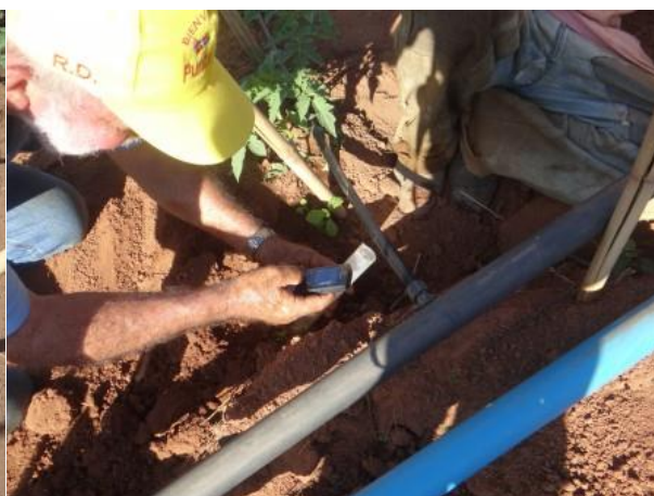
Coleta de água do emissor para caracterização hidráulica do sistema de irrigação por gotejamento na propriedade de João Batista da Silva Malta.
