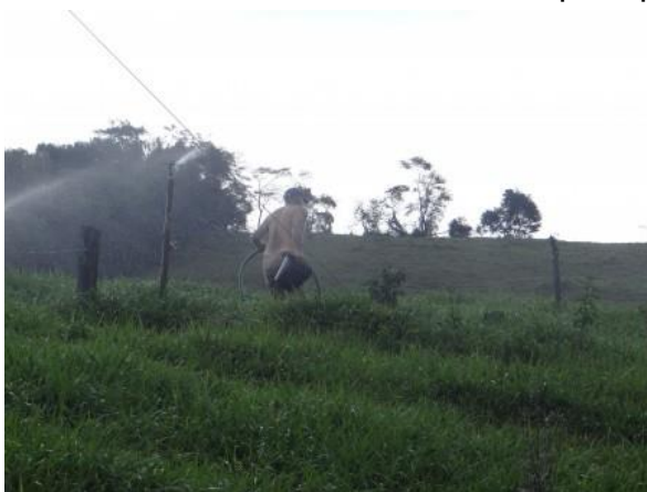
Coleta de água do aspersor para caracterização do sistema de irrigação por aspersão em piquetes, na propriedade de Wander Fernandes Ribeiro.
