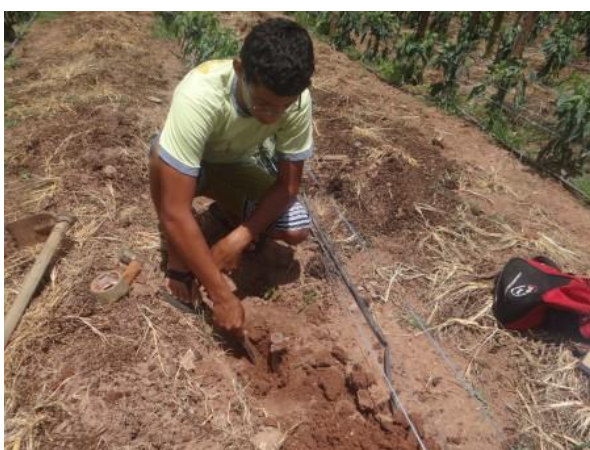
Amostragem do solo na propriedade de Thiago Marçal Gomes Moreira para sua caracterização físico-química.
