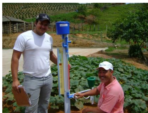
FIGURA 128. Instalação do Irrigâmetro na propriedade e treinamento do produtor José Alair Bissoli, do município de Afonso Cláudio - ES.
